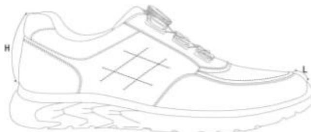
图3 成品尺寸测量部位示意图
